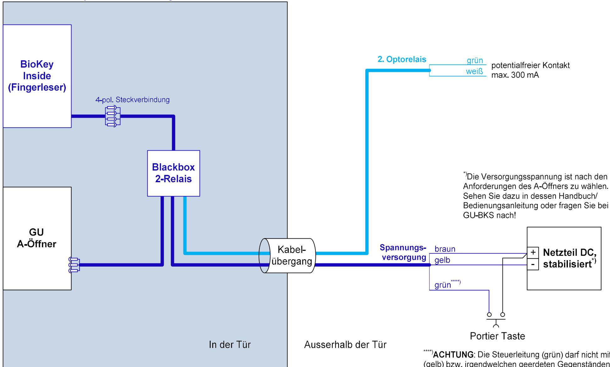
\*)Die Versorgungsspannung ist nach den Anforderungen des A-Öffners zu wählen. Sehen Sie dazu in dessen Handbuch/ Bedienungsanleitung oder fragen Sie bei GU-BKS nach!
