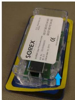
**3. Verbinden Sie das Relaiskabel mit dem SOREX Door Phone and Code Modul und setzen Sie es in die Tür bzw. in die Wand ein.**
